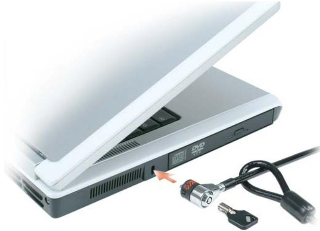
**OPTISCHER LAUFWERKSCHACHT** — Der Einbauschacht dient zur Aufnahme von DVD- oder anderen optischen Laufwerken. Weitere Informationen finden Sie unter „Optisches Laufwerk“ auf Seite 128.
