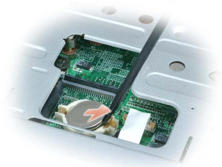
Wenn Sie die Batterie austauschen, schieben Sie sie mit dem Pluspol nach oben in einem Winkel von 30° unter die Klammer (Erkennbar am Pluszeichen, [+]), und drücken Sie sie dann fest.
